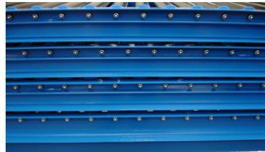
Zusätzliche Verstärkung des Walzenabschnitts
